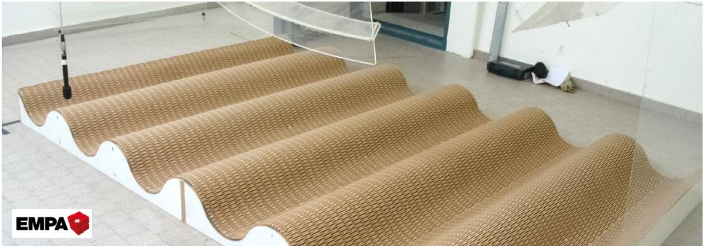
Messung des Schallabsorptionsgrads  $\alpha_s$  im Hallraum EMPA Dübendorf, CH
