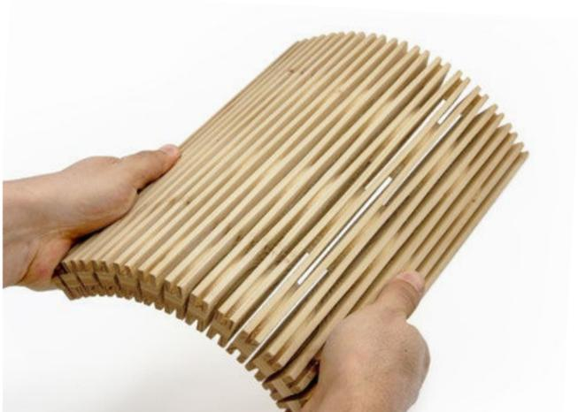
Der Schnitt-Typ **JANUS**, hat die gleiche Schnittgeometrie wie LINAR jedoch beidseitig. Dadurch können auch dicke Plattenwerkstoffe perforiert und in einem erstaunlich engen Radius gebogen werden. Durch die beidseitig gleiche Optik und die dickere Plattenstärke eignet sich JANUS vor allem für freistehende Anwendungen wie Trennwände.
