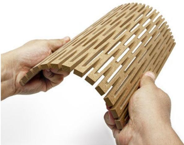
Beim Schnitt-Typ **SONAR** sind die regelmässig angeordneten Einschnitte in Längsrichtung an der Plattenoberfläche sichtbar abgesetzt. Dadurch entstehen optisch, neben den vertikalen auch horizontale Linien – eine Art Gitterstruktur. Idealerweise wird MDF für diesen Schnitt-Typ verwendet um mögliche Ausrisse im Holz zu vermeiden.
