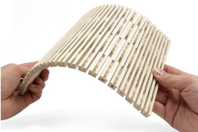
Die regelmässigen Einschnitte sind beim Schnitt-Typ **LINAR** oberflächlich durchgehend. Dadurch entsteht ein ruhiges und homogenes Schnittbild mit einem linearen Charakter. Dieser Schnitt-Typ ist auf Grund seiner Schnittgeometrie, im Vergleich zu den anderen Typen am stärksten biegsam. Neben der Ausführung in MDF eignet sich dieser Schnitt-Typ auch für Sperrholz und 3-Schichtplatten.
